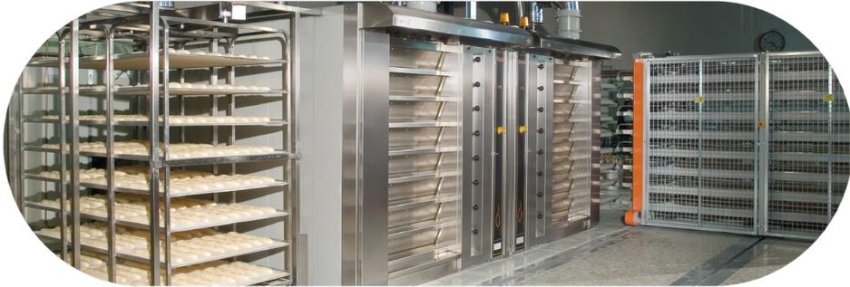
Diseñados para quienes buscan cocciones uniformes y de alta calidad. Su sistema de solera refractaria y vaporización independiente por cámara permite obtener una corteza perfecta y una cocción homogénea en todo tipo de productos. Disponibles en versiones a gas, gasoil o eléctricas, con controles digitales intuitivos y carga adaptable a cada producción.
